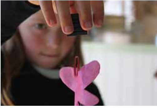
الشكل (٣-٢/ب): قوة جذب المغناطيس للمشبك عن بعد.
