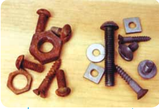
الشكل (٢-٥): براغ حديدية جديدة وأخرى يعلوها الصدأ.
