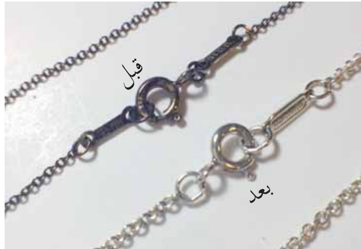
الشكل (٣-٤): قطع من الفضة قبل وبعد التفاعل مع رقائق الألمنيوم.
