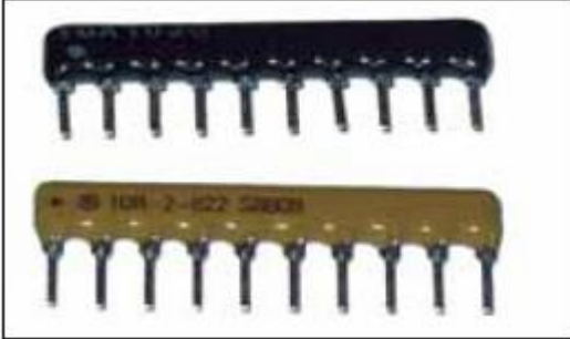
الشكل (10-1): مقاومات شبكية
