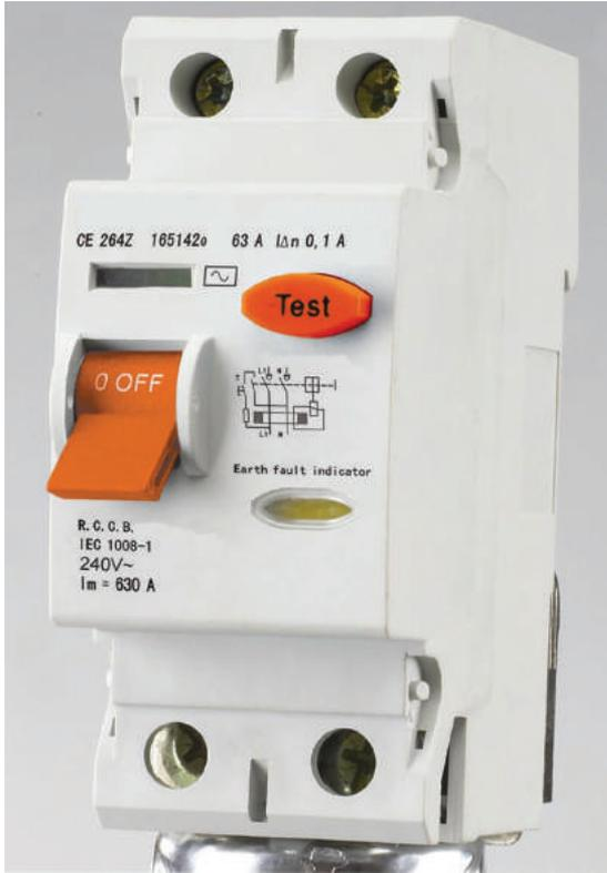
فهو الوقاية من الصدمة الكهربائية؛ لأن التيار المتسرب (30mA) يمكن أن يلحق ضرراً كبيراً بالإنسان عند ملامسته هياكل الأجهزة الكهربائية المعدنية المكهربة التي أصابها تلف عازل الكبلات. بمرور الزمن، وذلك بسريان تيار التسرب في الجسم وصولاً إلى نقطة التأريض، فإذا زاد تيار التسرب على حد معين تتوقف حركة عضلة القلب؛ مما يؤدي إلى الوفاة. ويبيّن الشكل (٢-١٧/أ) قاطع تيار فرقيًا أحادي الطور.
