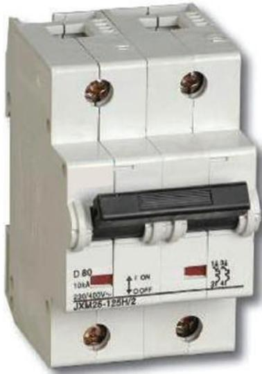
ارتفعت درجات الحرارة أعلى من ذلك، فإن مصدر الحماية الحراري يستجيب بصورة مبكرة، وهذا يعني أنه لا يمكن تحميل القاطع بتياره الاسمي. لذا، يجب الانتباه لهذه المسألة، خاصة عند استخدام مثل هذه القواطع في الفراغات التي ترتفع فيها درجة الحرارة، أو في اللوحات التي تتعرض للارتفاع المستمر في درجة حرارتها. جدير بالذكر أن قواطع (MCB) تعمل في ظروف وأحوال مناخية تصل فيها درجة
