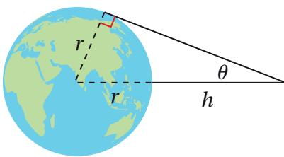
**أقمار صناعية:** عندما ترصد الأقمار الصناعية الأرض، فإنه يمكنها مسح جزء فقط من سطح الأرض. وبعض الأقمار الصناعية تحوي مستشعرات لقياس الزاوية  $\theta$  (بالراديان) المبينة في الشكل المجاور.
